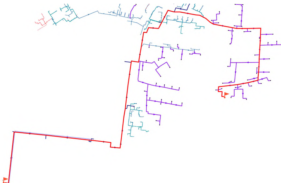
Рисунок 2.15 - Путь теплоносителя по направлению от котельного цеха №7 до потребителя «ПП_222_2030»
